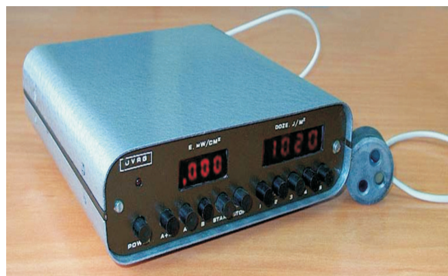
Fig. 1. Măsurător cu afișaj digital de radiație ultravioletă.
