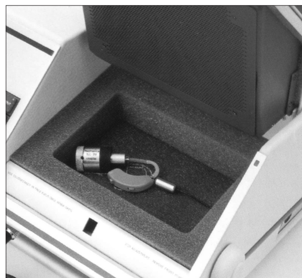
Fig. 2. Cuplor pentru testarea parametrilor protezei auditive.
